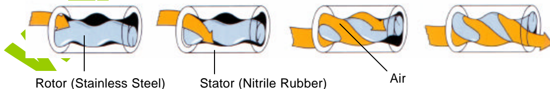
Gambar Proses Pemompaan pada Progressive Cavity Pump
